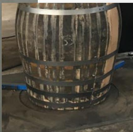
Dispone de guías en la base para el centrado rápido de la colocación de la barrica.
